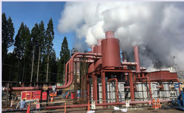
秋田県湯沢市小安地域での地熱調査井仮噴気試験の様式(2017年11月)
